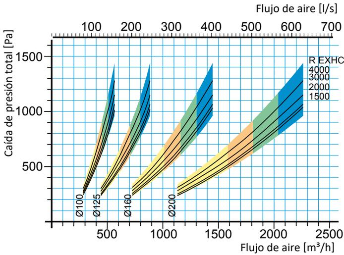
La línea negra representa la caída de presión del brazo cuando se encuentra en la misma posición que en la imagen anterior. El área del diagrama muestra la caída de presión con un uso normal. Los distintos colores indican la velocidad del aire en el extractor según las siguientes especificaciones.
